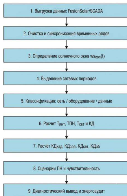
Рис. 3. Численная реализация модели по мониторинговым данным FusionSolar/SCADA.
