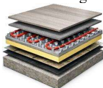
3-rasm. Zamonaviy gidronik issiq pol tizimining 3D qatlamli tuzilmasi.
