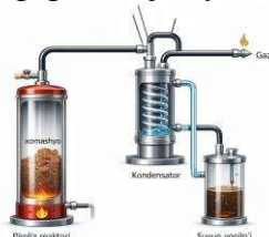
2-rasm. Sodda ko‘rinishdagi piroliz jarayoni.
