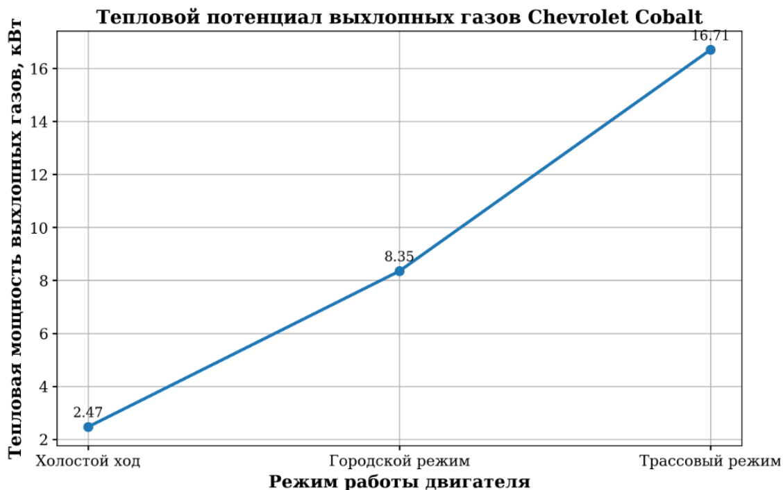
Рис.1. Тепловой потенциал выхлопных газов Chevrolet Cobalt
