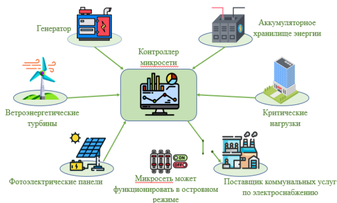
Рис. 1. Схематическая модель архитектуры гибридной микросети с интеграцией возобновляемых источников энергии, системами хранения и возможностью автономного (островного) функционирования [7].
