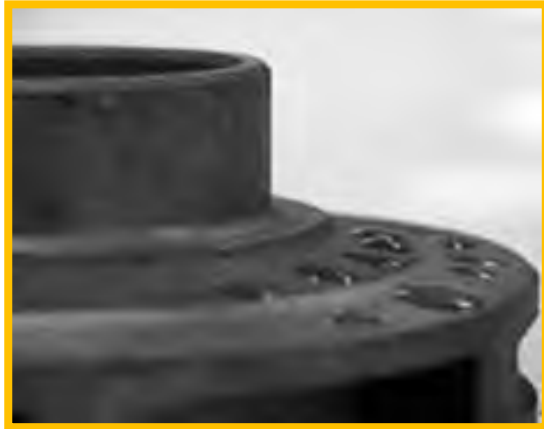
a) asl holati; b) gidrofob qoplamasi orqali takomillashtirilgandan so'ng 1 – rasm. Markazdan qochma nasos uskunasi ishchi g'ildiraklari.
