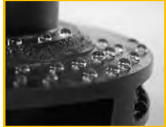
a) asl holati; b) gidrofob qoplamasi orqali takomillashtirilgandan so'ng 1 – rasm. Markazdan qochma nasos uskunasi ishchi g'ildiraklari.
